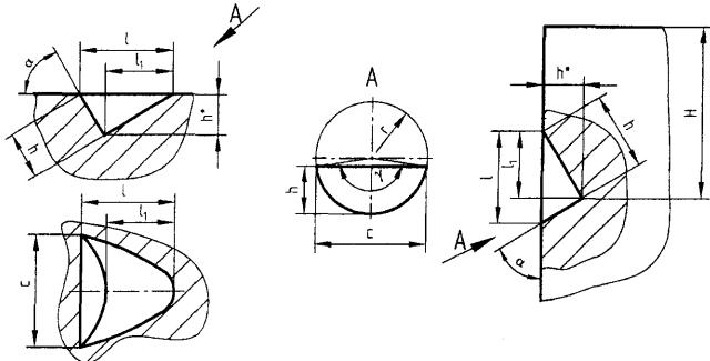
Рисунок Е.1 - Размеры сегментных отражателей
