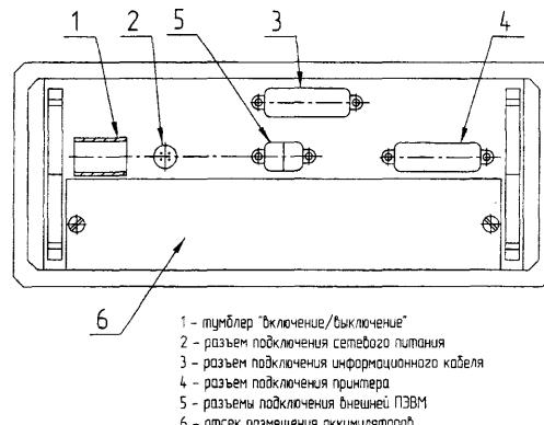
Рисунок Ж.2 - Задняя панель дефектоскопа
