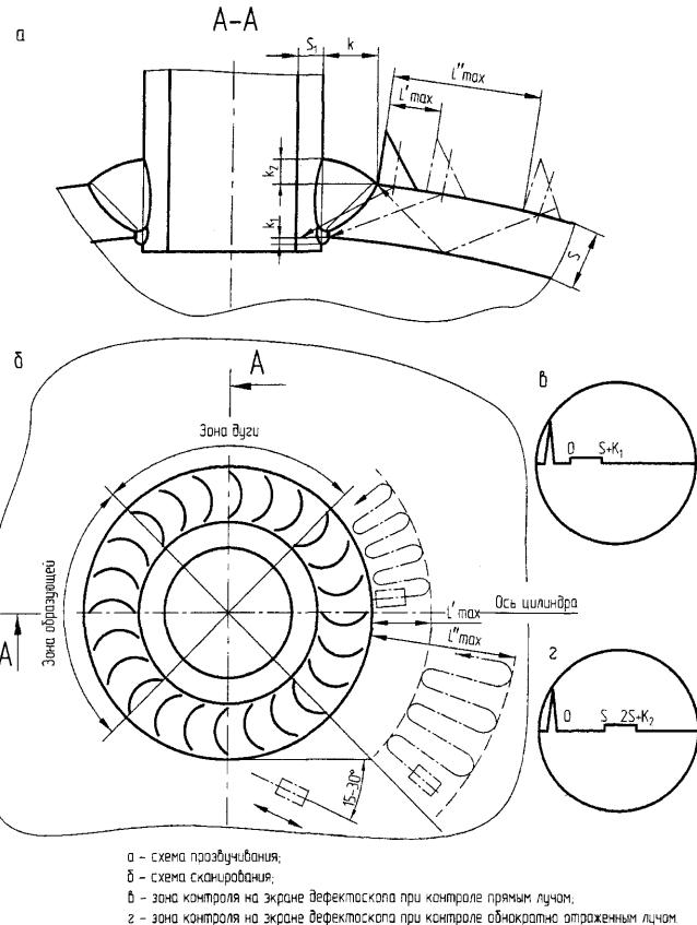
Рисунок 18 - Схема контроля сварных соединений прямым и однократно отраженным лучами по поверхности корпуса при малых радиусах кривизны корпуса
