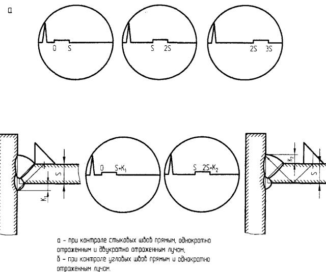
Рисунок 9 - Схема установки зоны контроля
