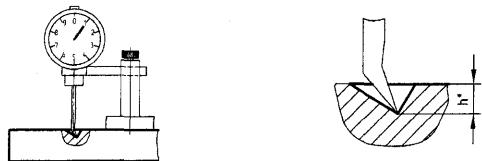
Рисунок Е.2 - Схема измерения глубины фрезерования сегмента
