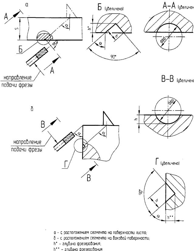
Рисунок Б.1 - Варианты исполнения сегментных отражателей
