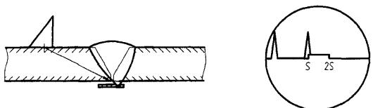
Рисунок 13 - Схема выявления эхо-сигнала от непровара и осциллограмма
