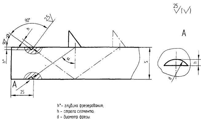
Рисунок 2 - Расположение сегментного отражателя в СОП
