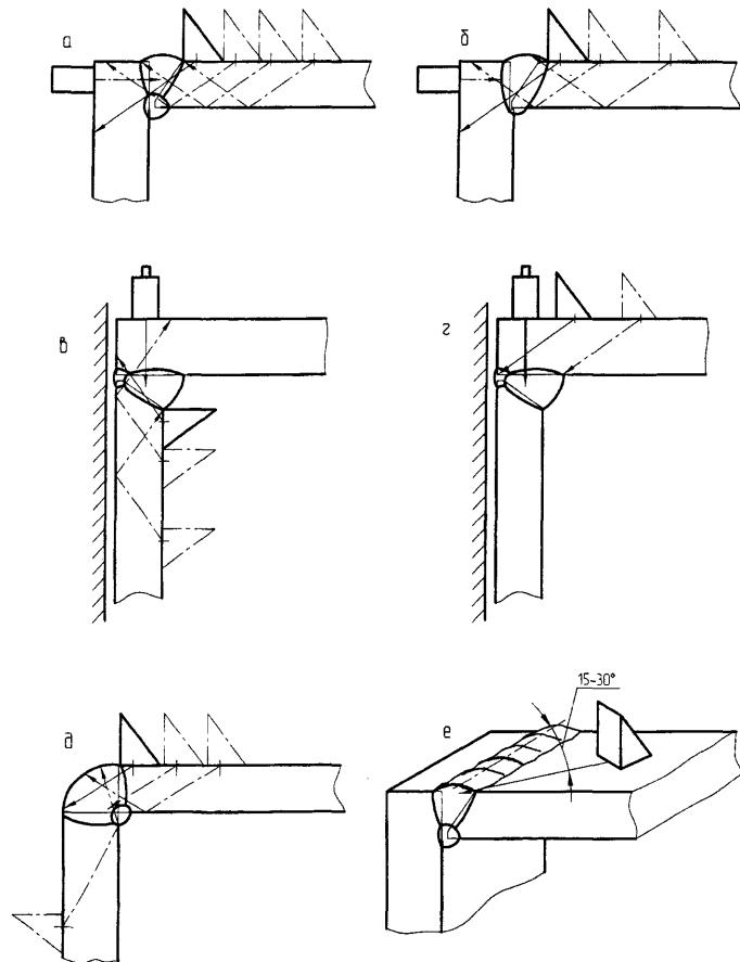
Рисунок 16 - Схема контроля угловых сварных соединений
