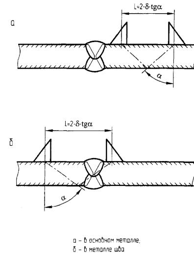
Рисунок В.1 - Схема когроля для определения величины относительного затухания ультразвуковых колебаний
