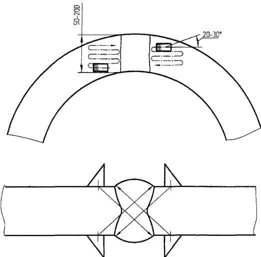
Рисунок 25 - Контроль сварных соединений фланцев
