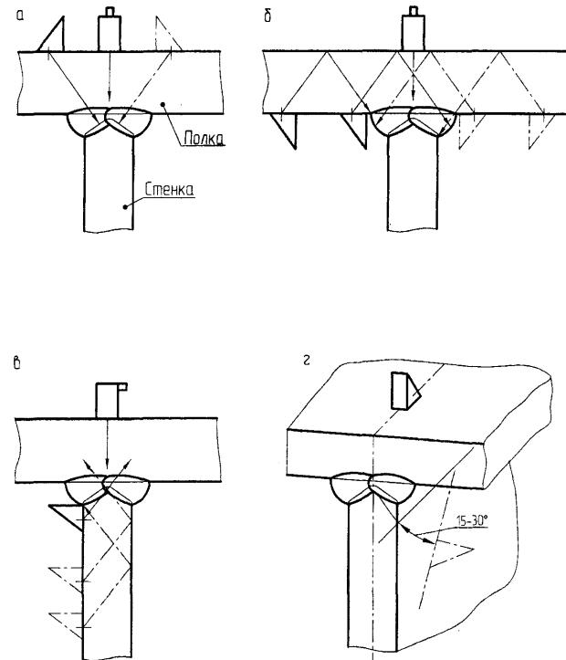
Рисунок 17 - Схема контроля тавровых сварных соединений
