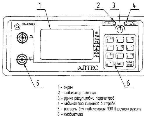
Рисунок Ж.1 - Передняя панель дефектоскопа
