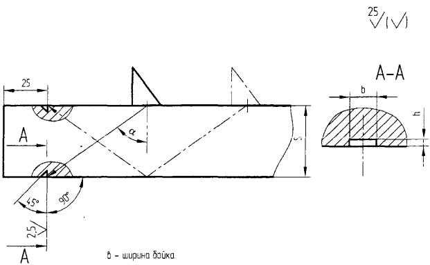
Рисунок 3 - Расположение углового отражателя в СОП
